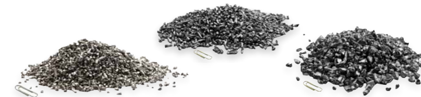
Granalla - varios tamaños después del Granulador FG y la Mesa Separadora
